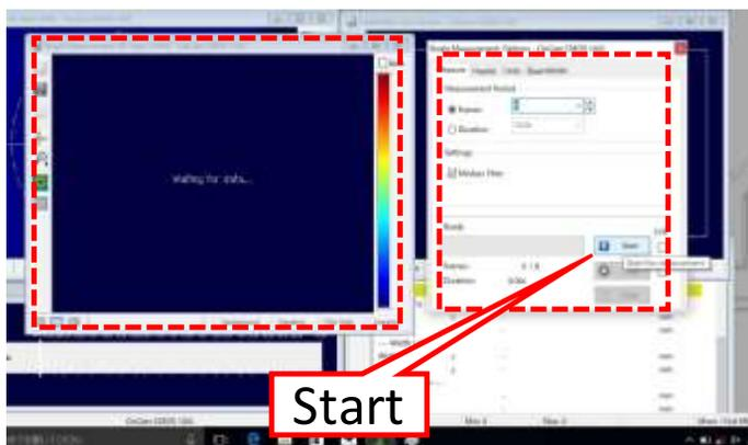
3. データ取得が終わると、「Single Measurement: 2D-View」に取得した2Dデータ（静止画）が表示されます。データを消して取り直すときは再度「Start」をクリックしてください。
